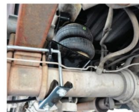
Suspension à air installée post-construction
