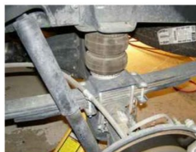
Suspension à air installée post-construction
