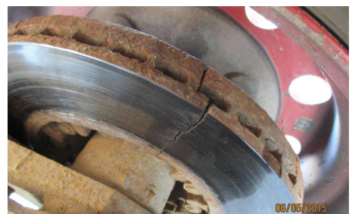
Disco Agrietado. Criterios de Fuera de Servicio, Parte II, g.(2) / 393.47(a)-EUA
