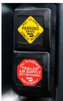
Frenos de Estacionamiento NO Activados - Ni Tractor Ni Remolque.
