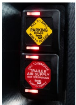
Frenos de Estacionamiento Activados - Tanto Tractor como Remolque.
