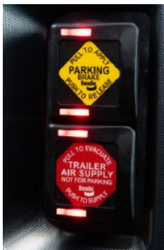
Freins de stationnement activés sur le tracteur et la remorque
