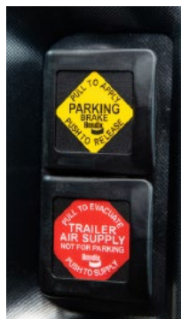
Freins de stationnement inactifs sur le tracteur et la remorque
