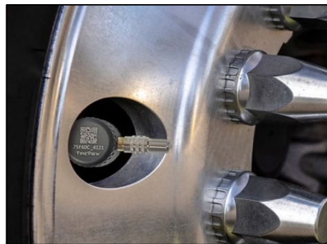
Contrôlez l'air au niveau du capteur à flux continu
