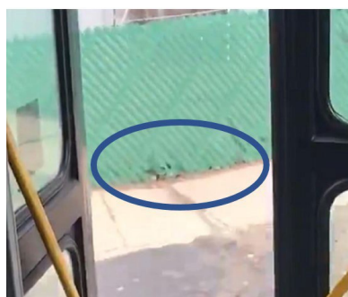
Solo se abre un lado de la puerta doble cuando se activa la liberación. La apertura de una puerta permite el paso adecuado del elipsoide a través de la salida.
