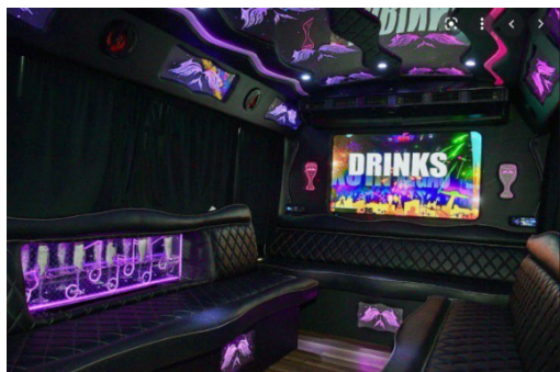
Puerta trasera bloqueada por un gran televisor y asiento perimetral. No se ha instalado una escotilla en el techo para cumplir con el requisito de salida trasera.
