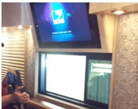
Salida diseñada para presionar los pasadores y levantar la ventana fuera del riel. La TV y paneles instalados permiten el acceso y su retiro según lo diseñado.
