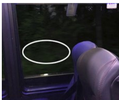
El monitor de TV y el respaldo alto del asiento dividen el espacio de la salida de emergencia, pero aún permite el paso a través de la salida.
