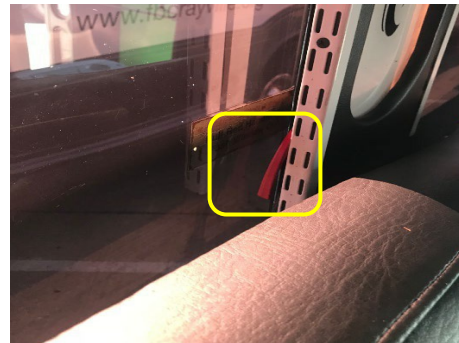
Panel personalizado y respaldo del asiento bloqueando el mecanismo de liberación, haciendo que la salida no funcione.
