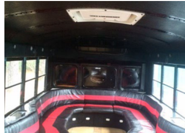
Este autobús escolar convertido ya no cumple con la Opción A del Método Dos debido a la eliminación de la puerta de salida trasera. Se ha agregado una escotilla en el techo para cumplir con el Método Uno.
