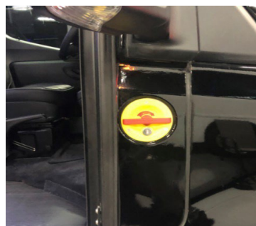
Válvula de liberación de puerta en el exterior de una limusina personalizada, en la puerta de entrada.
