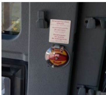
Válvula de liberación de puerta en el interior de un autobús en la puerta de entrada.
