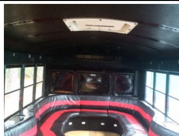
Cet autobus scolaire converti ne répond plus à la méthode deux, option A en raison du retrait de la porte de sortie arrière. Une trappe de toit a été ajoutée pour se conformer à la première méthode
