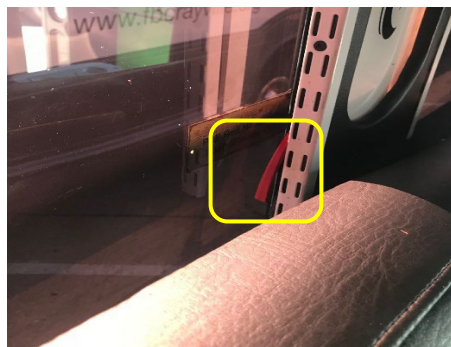
Panneau personnalisé et dossier de siège bloquant le mécanisme de déverrouillage rendant la sortie inopérante.
