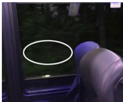
Moniteur de télévision et siège arrière haut divisant l'espace de sortie de secours tout en permettant le passage à travers la sortie.
