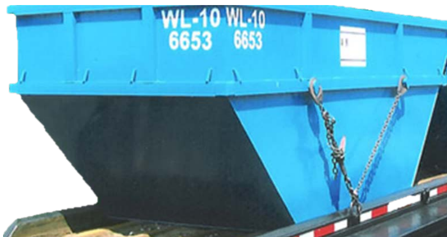
Exemple: Appareils d'arrimage installés et sécurisés sur les deux côtés.
