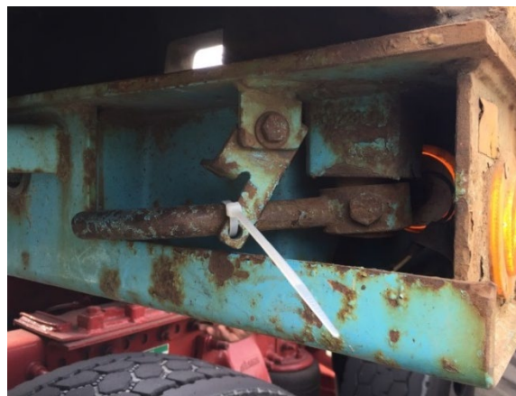
Figure 4 : Utilisation d'attaches additionnelles de type "Tie-Wrap"
