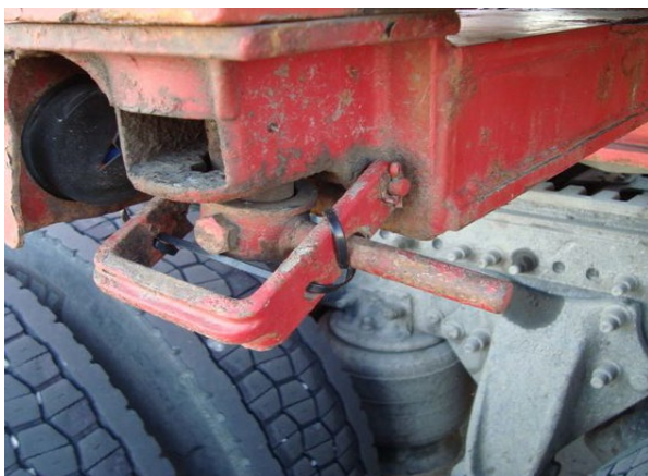
Figure 4 : Utilisation d'attaches additionnelles de type "Tie-Wrap"
