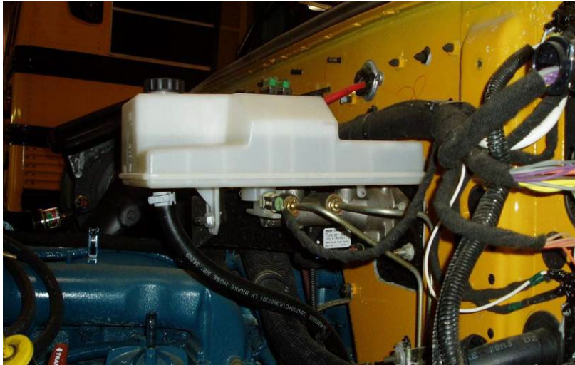
Este es el cilindro maestro montado sobre la pared contrafuegos.
