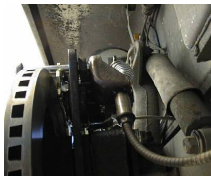
Exemples de freins de stationnement sur les roues et sur la transmission
