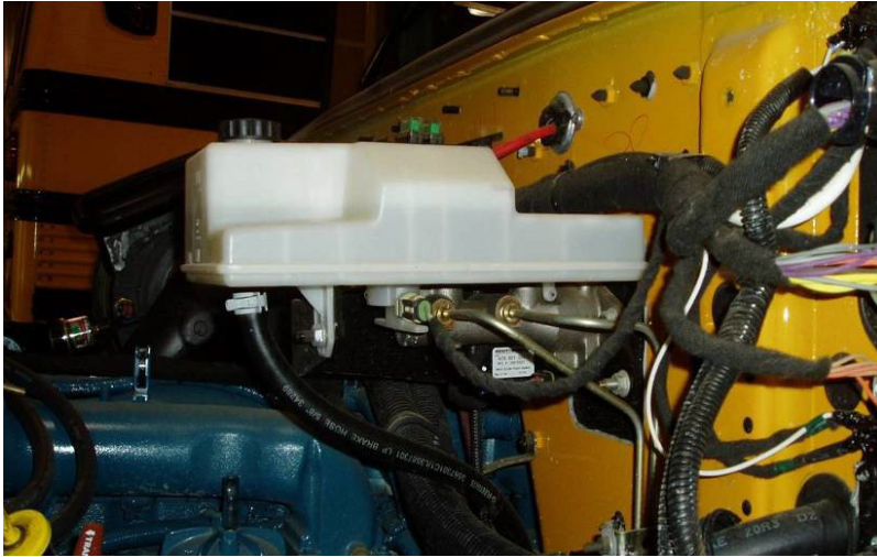
Maître-cylindre installé sur le tablier
