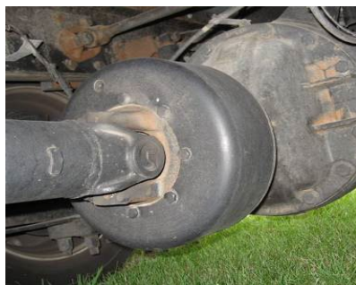
Exemples de freins de stationnement sur les roues et sur la transmission
