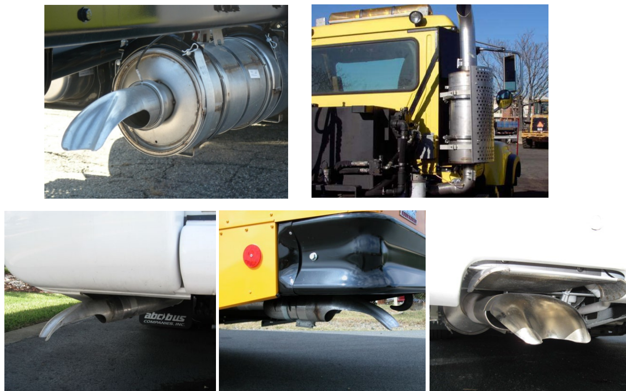
Figura 1: fotografías del chasis de un camión, autobús escolar y colectivo con sistemas de escape nuevos.
