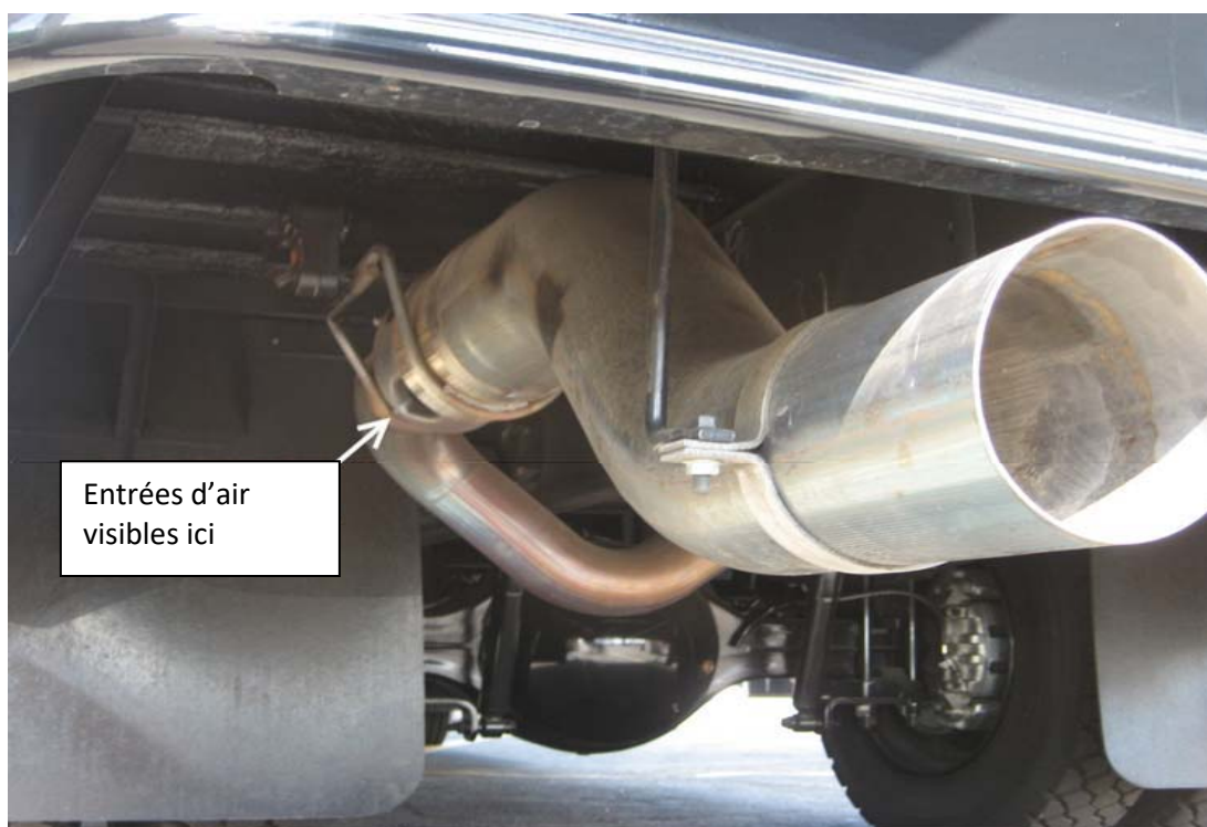
Figure 4 – Sortie d'échappement avec dissipateur de chaleur et entrées d'air avant visibles.
