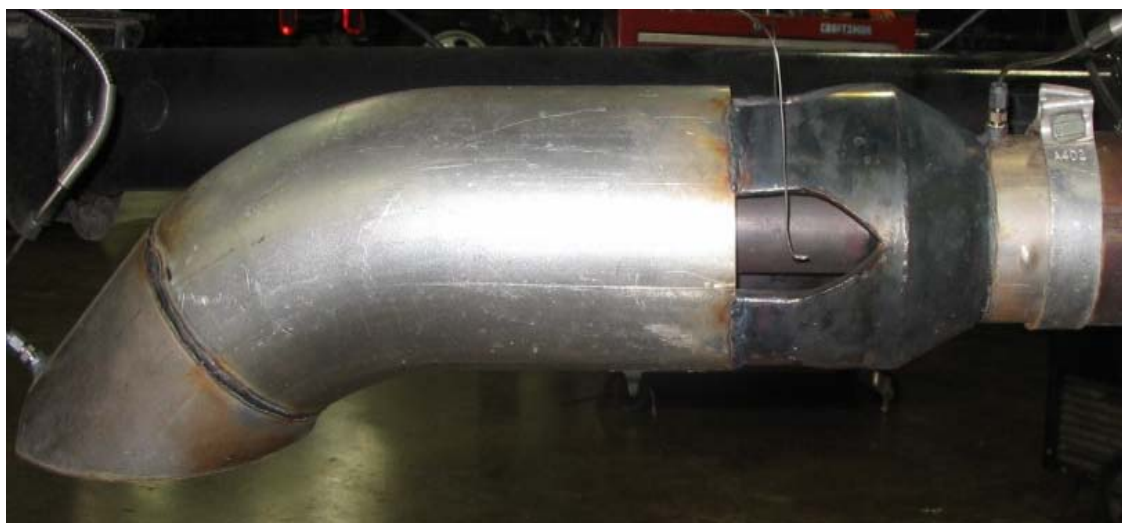
Figure 4 – Sortie d'échappement avec dissipateur de chaleur et entrées d'air avant visibles.
